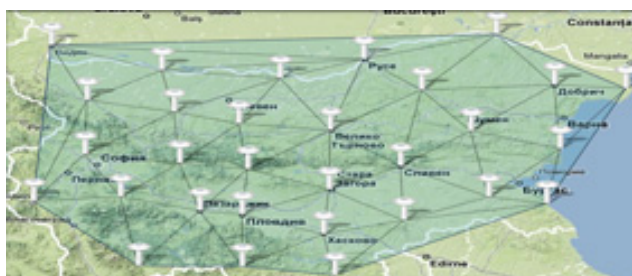
Фигура 2.3: Мрежа от наземни ГНСС станции - „Зенит-Гео“.
