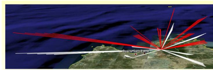
Фигура 4.2: Път на наклонените ГНСС закъснения от 9 спътника, получени за един наземен приемник за 15 минутен интервал от време.
